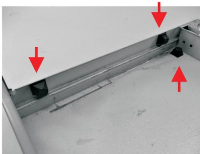
An jede Ladenseite im Bereich des INKiESS Schubladeneinsatzes 7810 RE entsprechend Abbildungen je zwei Abstandhalter vorn und hinten befestigen. Sie dienen der seitlichen Fixierung des Einsatzes.
