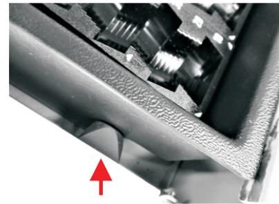
Den INKiESS Schubladeneinsatz 7810 RE einsetzen und nach vorn schieben. Anschließend als hintere Fixierung des Einsatzes die beiden restlichen Bumpons auf dem Boden der Lade befestigen.
